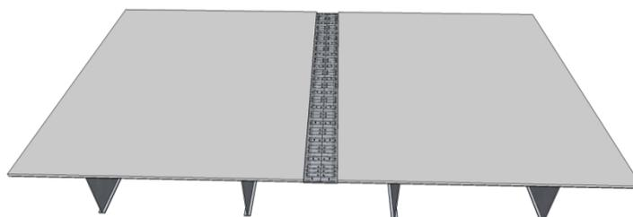
图 10 STC 接缝应设于低应力区
